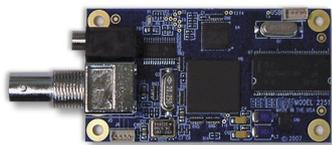
La scheda PC104 presente all'interno della UPRv4 si occupa di acquisire il segnale video attraverso il frame grabber collegato all'uscita video della telecamera, si occupa di comandare il movimento dell'azimuth e di acquisire i valori dalla unità di rilevamento nell'infrarosso in
